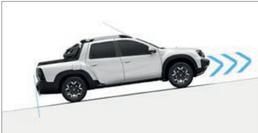
asistente de arranque en pendiente (HSA) Mantiene la presión de los frenos durante dos segundos, evitando que retroceda al momento de arrancar cuando te encuentras en una pendiente.
