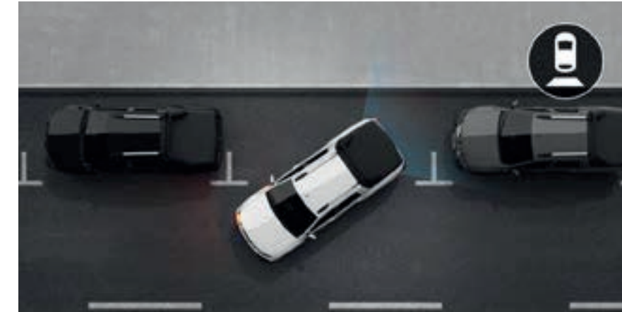
cámara trasera Muestra la vista desde atrás en la pantalla táctil multimedia mientras vas de reversa. Las guías hacen las maniobras más fáciles y simples.
